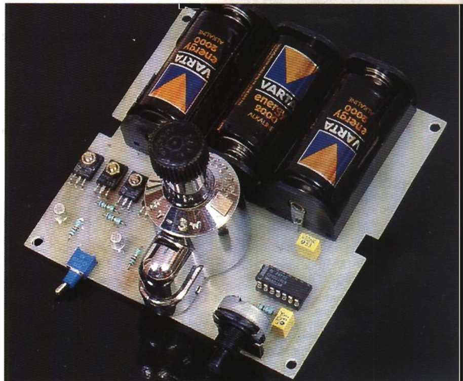
Photo 2. - Les trois piles reposent à même le circuit imprimé
