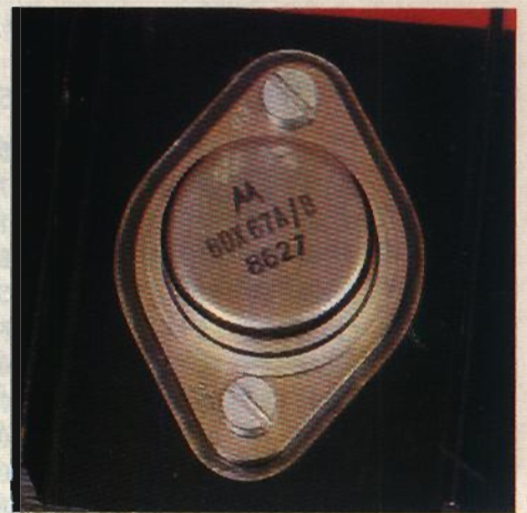
Photo 7. - Le transistor de sortie subit un refroidissement efficace grâce au radiateur placé sur la face arrière.
