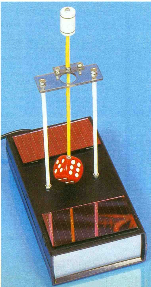
Photo 5. - Le mobile solaire tout monté et prêt à l'emploi.
