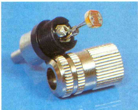
Photo 4. - Réalisation de la sonde avec sa LDR.
