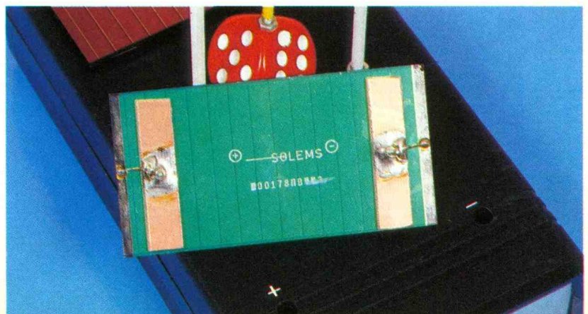
Photo 4. – Câblage du capteur photovoltaïque.
