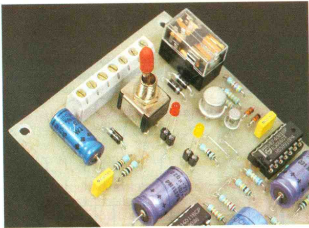
Photo 3. – Le bornier de sortie permet toutes les interconnexions avec l'extérieur.
