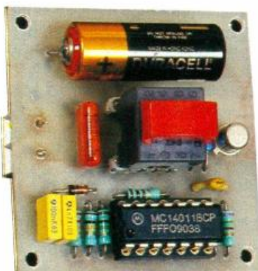
Photo 2. - L'émetteur dispose d'une pile miniature 12 V.
