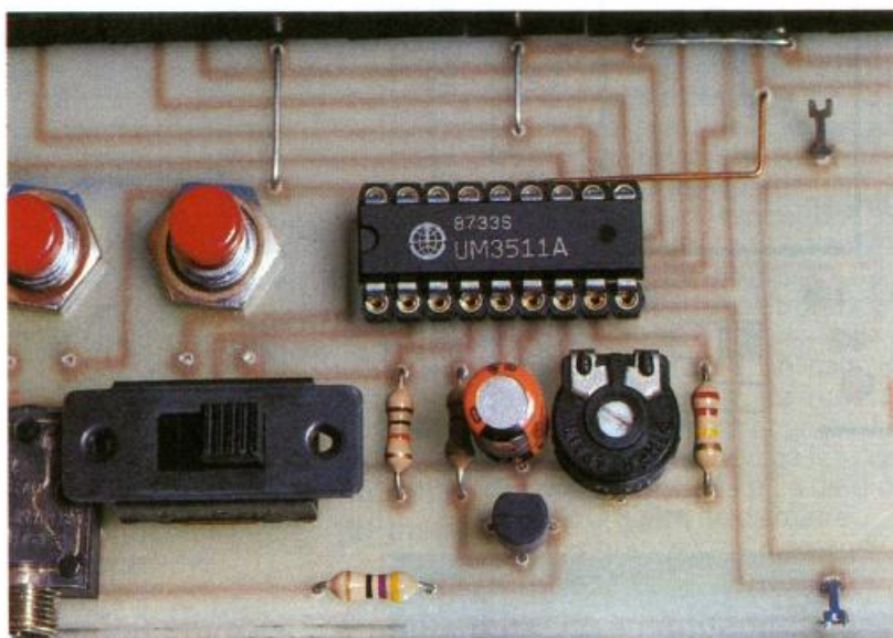
Photo 3. – La platine toute montée, elle dispose d'une sortie auxiliaire par une fiche « Jack ».
