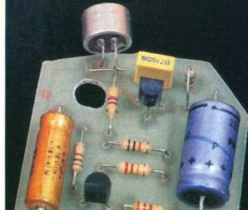
Photo 3. – Le micro-électret capte les sons à l'intérieur du véhicule.
