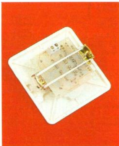
Photo 5. – L'émetteur se loge dans un boîtier encastrable.
