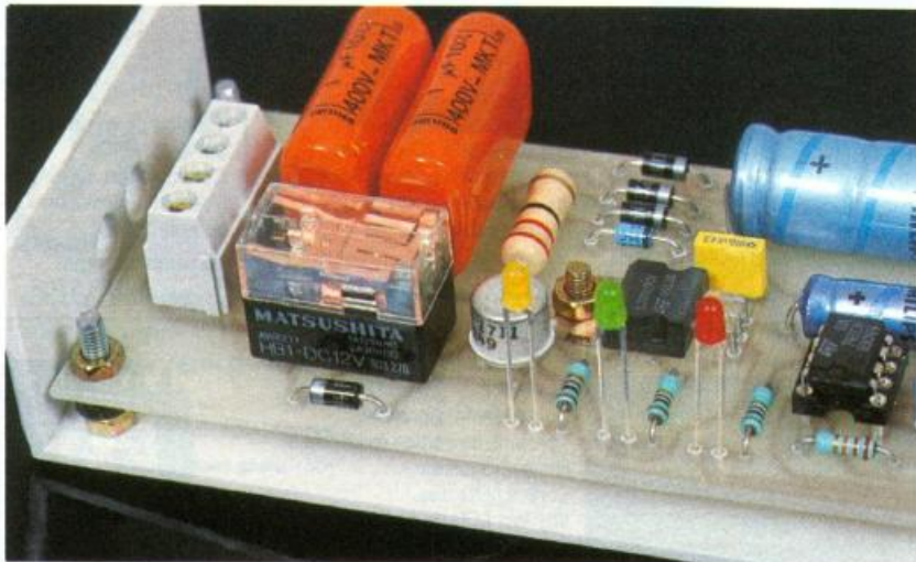
Photo 3. – Vue sur le relais de sortie.
