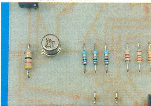
Photo 2. - Vue sur le régulateur de tension SFC 2309.
