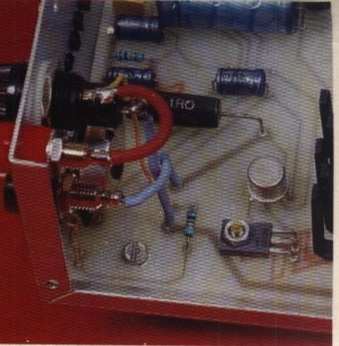
Photo 4. - Le câblage des fiches banane et du fusible.
