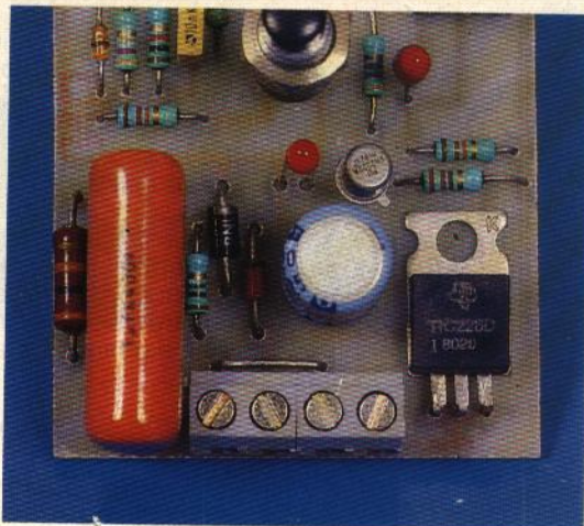
◀ Photo 3. - Le phototransistor capte le rayonnement IR du boîtier de télécommande. Photo 2. - Le bornier autorise le raccordement au secteur et à la charge. ▼
