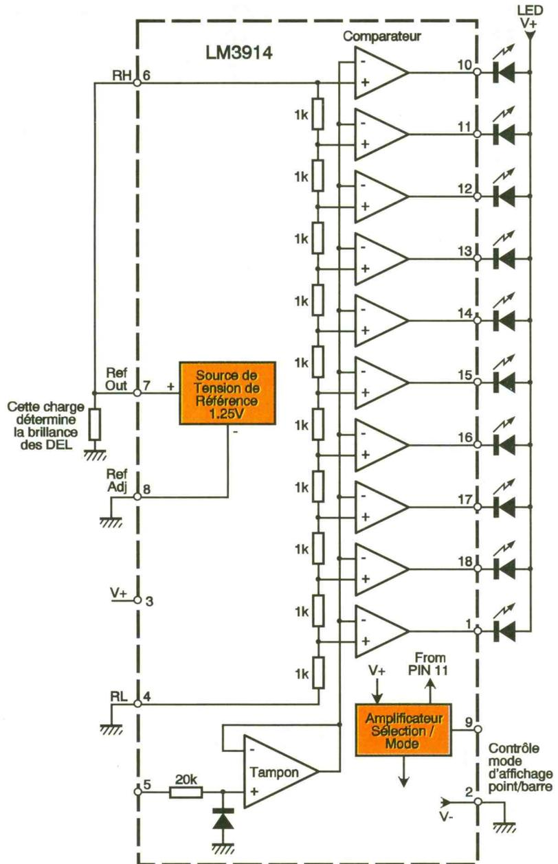
20 à 100 segments, et comme les deux extrémités du diviseur de tension sont accessibles, un instrument de mesure à zéro central peut être obtenu avec deux circuits. L'utilisation du LM3914 comme circuit de mesure analogique est très facile. Pour une mesure de 1,2V de pleine échelle, seulement une résistance et une alimentation unique de 3 à 15V sont nécessaires en plus des
