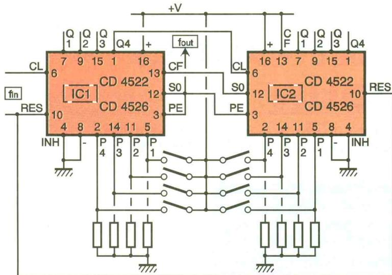
En utilisant, par exemple, deux CD 4526, on obtient sur la sortie  $S_0$  de  $IC_1$  des impulsions positives dont la fréquence se trouve divisée par un nombre « N », par rapport à celle que l'on présente sur l'entrée « Clock » de  $IC_1$ .
