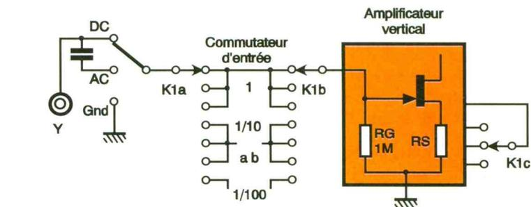
**5a ATTENUATEUR D'ENTREE D'UN OSCILLOSCOPE.**
