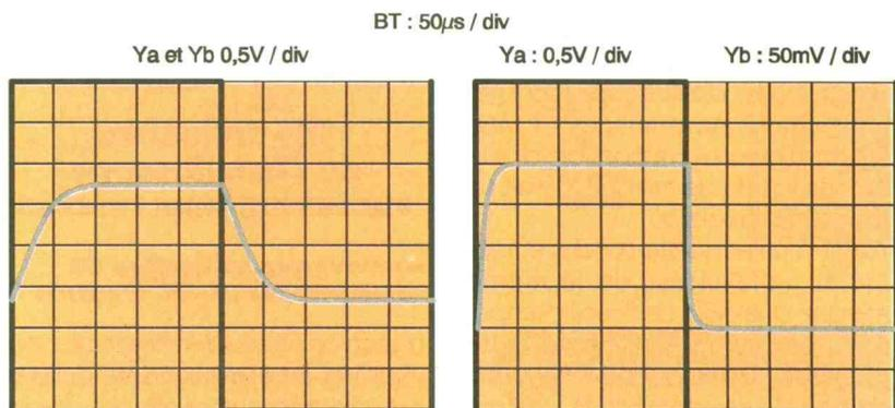
connexion, il est possible que l'on note quelques écarts dus à la capacité propre de ces plaques qui intervient à la fois au niveau de  $R_1$  et de  $R_2$ .
