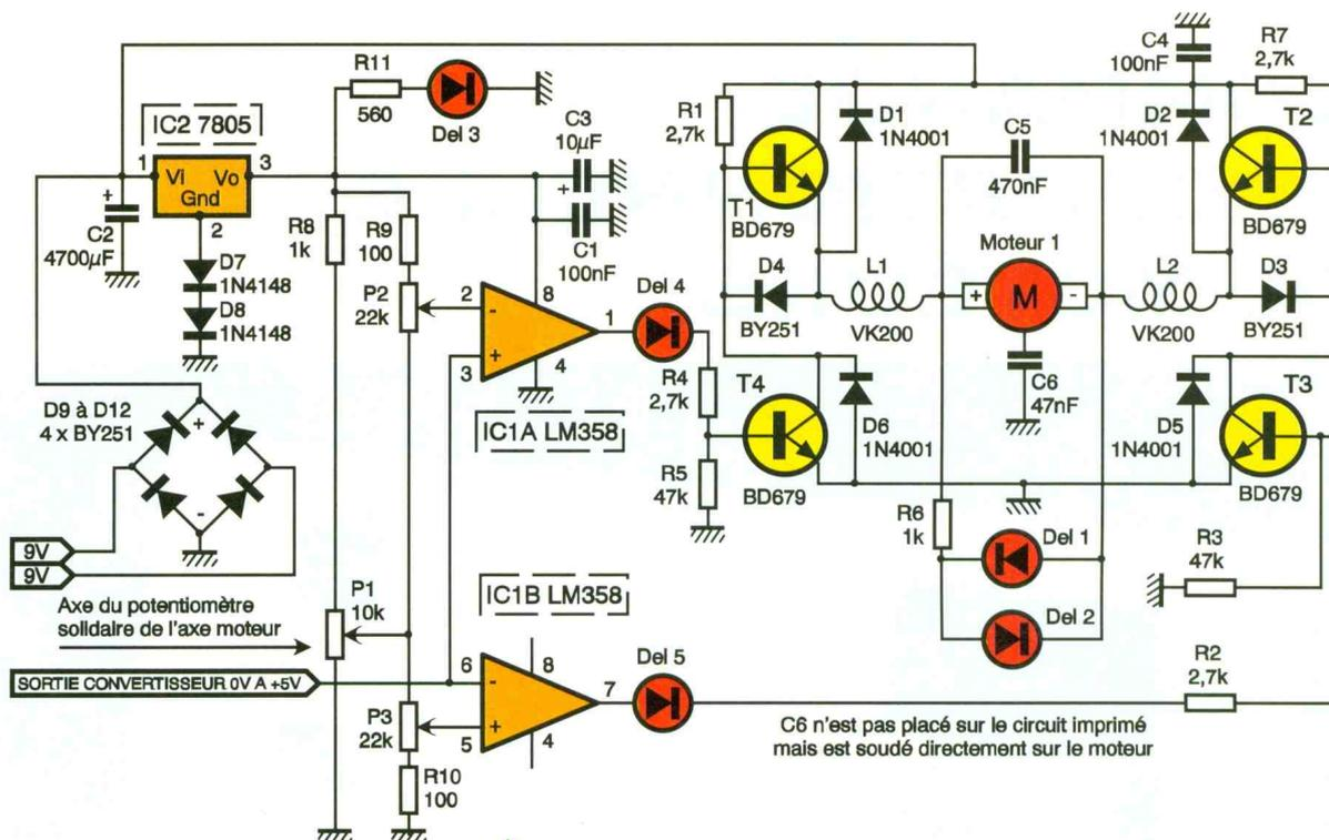
C6 n'est pas placé sur le circuit imprimé mais est soudé directement sur le moteur
