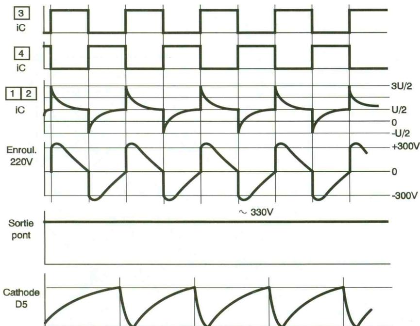
$T_7$  se met à conduire. En particulier, et par l'intermédiaire de  $R_{11}$  et de  $D_8$ , un courant circule à travers la jonction gâchette-cathode du thyristor de commande. Ce dernier devient alors conducteur et la capacité  $C_7$  se décharge brutalement dans l'un des enroulements de la self de déclenchement. Dès que la capacité  $C_7$  est déchargée, c'est-à-dire en moins de quelques millisecondes, le thyristor
