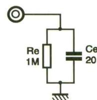
sondes adaptées à ses appareils. Néanmoins, comme les impédances d'entrées des oscilloscopes sont généralement normalisées ( $1\text{ M}\Omega$ ,  $20\text{ pF}$ ), il est souvent possible d'utiliser une sonde de marque X avec un scope de marque Y.
