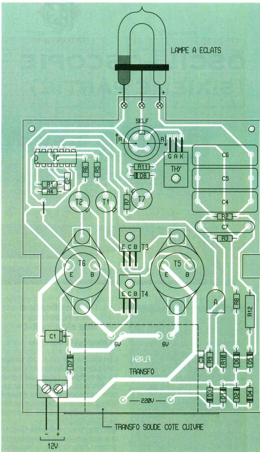
**T<sub>5</sub> ET T<sub>6</sub> FONT OFFICE DE TRANSISTORS DE PUISSANCE.**
