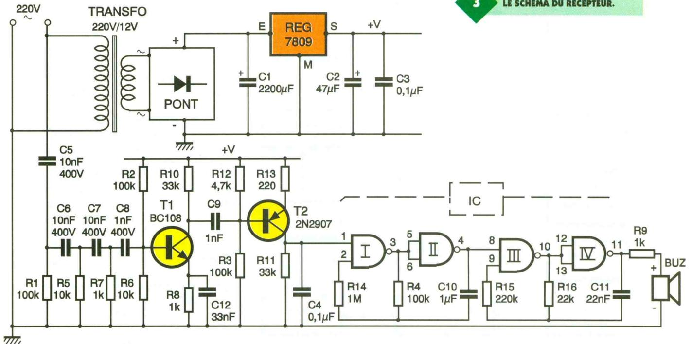
Les signaux ainsi amplifiés sont injectés dans le secteur de distribution par l'intermédiaire de  $C_{10}$ . La diode Zener  $D_Z$  protège le transistor  $T_2$  de toute surtension éventuelle en provenance du secteur via la capacité de liaison  $C_{10}$ .
