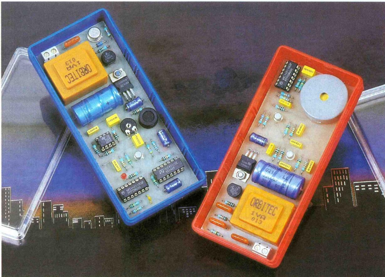
**Ce montage fait essentiellement appel à la technique des courants porteurs qui consiste à utiliser, en guise de liaison entre un émetteur et un récepteur, les fils de distribution du secteur 220 V d'un même appartement ou habitation.**
