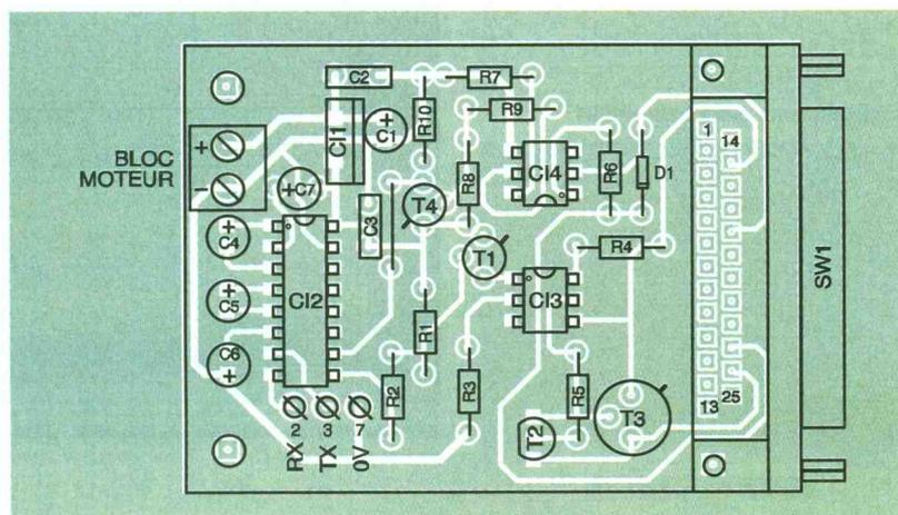
conducteurs. Vous prendrez soin d'effectuer les shunts d'usage en connexion RS 232 directement au niveau de la fiche. Pour une DB25, les broches 4 et 5 doivent être shuntées, et, par ailleurs, les trois broches 6, 8 et 20 sont à relier ensemble.
