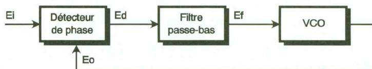
Pour mieux comprendre le fonctionnement de la boucle, considérons qu'initialement la boucle ne soit pas verrouillée mais que les fréquences des signaux Ei et Eo soient très proches. Dans ces conditions, Ed est un battement dont la fréquence est la différence des fréquences de Ei et Eo. Ce signal est appliqué à l'entrée du VCO si sa fré-
