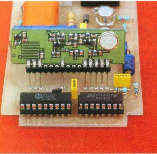
perchlorure de fer. Après un abondant rinçage à l'eau tiède, toutes les pastilles sont à percer à l'aide d'un forêt de 0,8 mm de diamètre. Certains trous seront à agrandir à 1 ou 1,3 mm suivant le diamètre des connexions des composants auxquels ils sont destinés.
