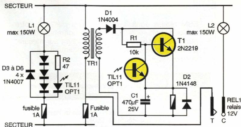
dans une applique ou un lampadaire, son encombrement doit être aussi faible que possible, tout en garantissant une isolation suffisante des parties au potentiel du secteur. L'emploi d'un transformateur d'alimentation est peu pénalisant de ce point de vue par rapport à la solution à condensateurs: vu sa puissance, le transformateur est un peu plus gros que les deux condensateurs de 1  $\mu$ F/400V et des quelques composants qui devraient le remplacer et apporte une sécurité incomparable.
