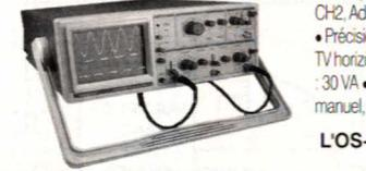
Bande passante : DC à 20 MHz (-3 dB) • Ecran : 8 x 10 cm • Mode : CH1, CH2, Add, Dual, Chop, Alt • Sensibilité : 5 mV/cm à 5V/cm en 10 calibres • Précision : ±3% • Loupe : x5 • déclenchement : Auto, Normal, TV vertical, TV horizontal • Base de temps : 200 ns/cm à 0,2 s/cm • Consommation : 30 VA • Dimensions : 320 x 135 x 320 mm • Poids : 6,8 kg. Fourni avec manuel, cordon secteur, fusible de recharge, béquille.
