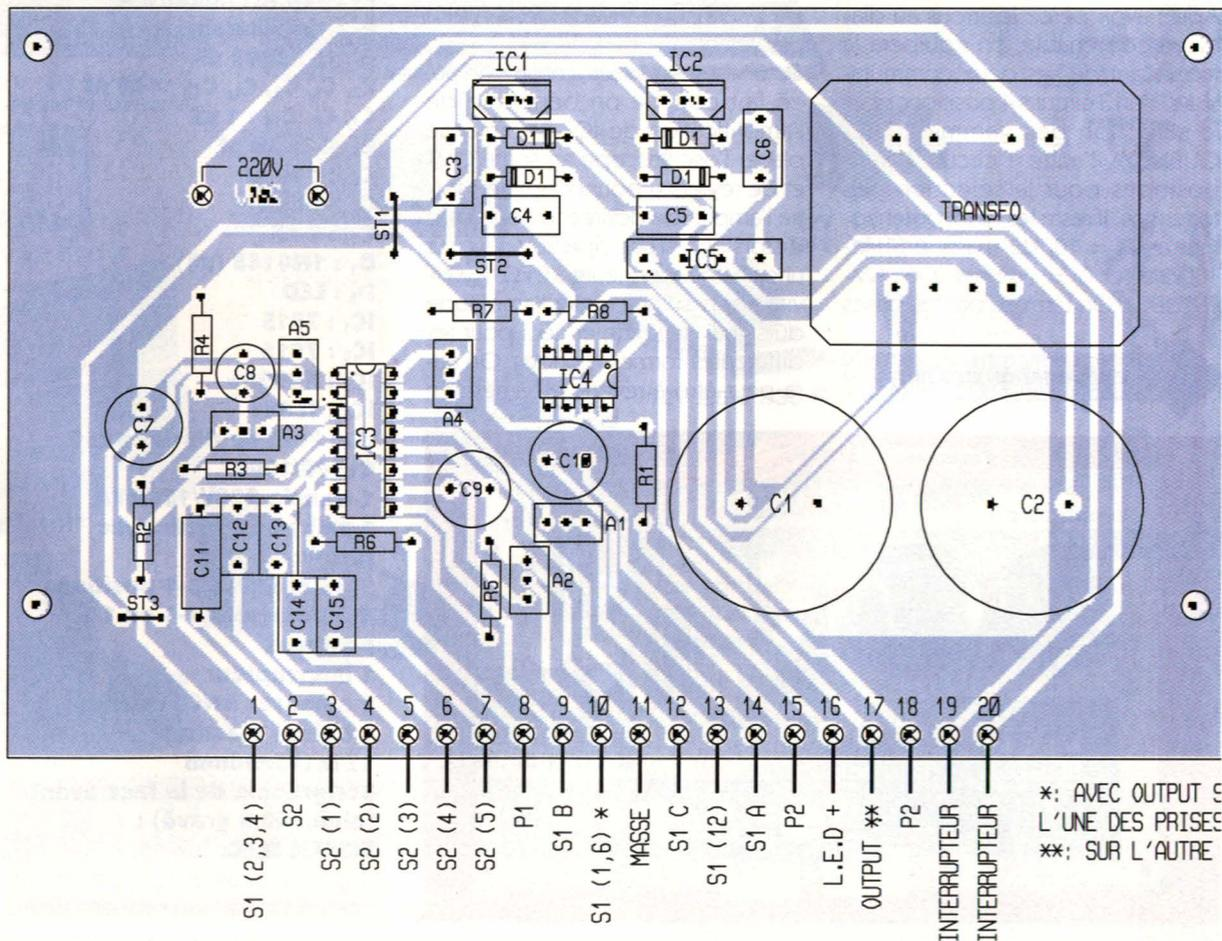
qui permettent de réunir les circuits intégrés aux commutateurs de la face avant ont été rassemblés sur un bord de la plaquette. A partir du dessin côté cuivre, il est facile de reproduire un mylar qui permet l'insolation d'une plaquette d'époxy cuivrée présensibilisée par ultra-violets.
