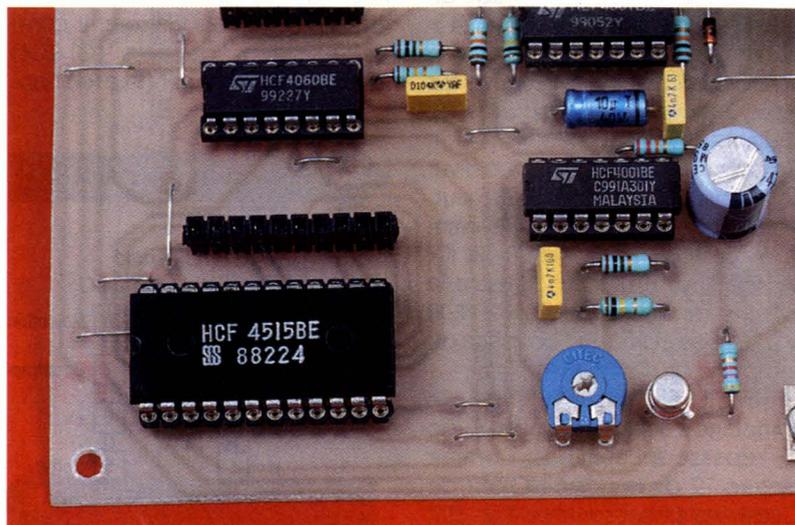
gée et de la 1ère colonne. Le signal alors disponible sur la sortie OUT de IC<sub>6</sub> est en fait l'addition de deux signaux sinusoïdaux de 770 Hz et de 1209 Hz (voir tableau des fréquences en **figure 3c**).
