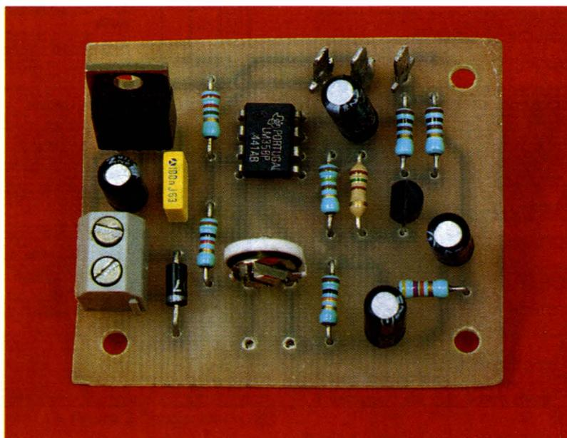
L'utilisation d'une diode laser passe avant tout par son alimentation, qui détermine la puissance lumineuse du faisceau laser. Le montage a été prévu pour des diodes laser émettant dans le visible tel que le modèle CQL80D de chez Philips, que l'on rencontre généralement dans des applications de pointeur laser ou de code à barres.
