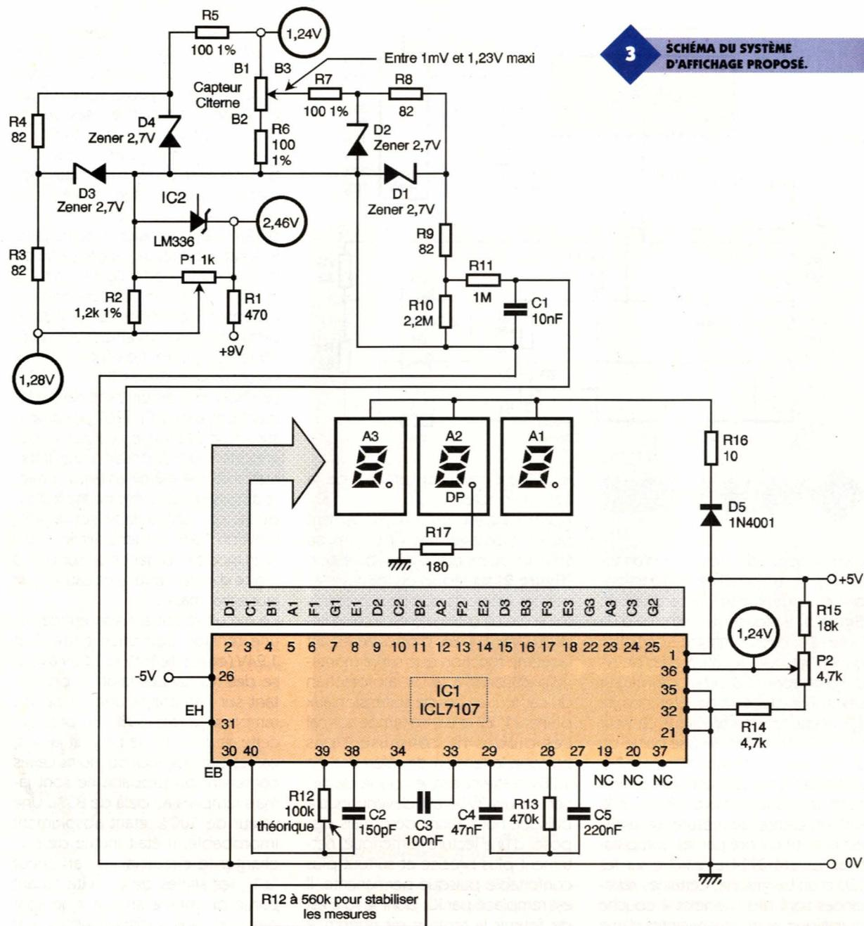
une correspondance unitaire milli-volt/pourcentage. La diode  $D_5$  permet quant à elle de chuter de 0,6V la tension appliquée sur la résistance  $R_{16}$  qui sera donc un modèle 1/4W, elle a pour rôle de modérer l'appétit vorace des afficheurs à LED.
