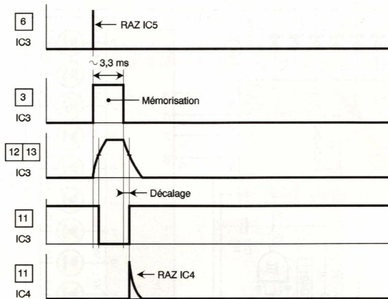
fronts montant et descendant bien verticaux grâce à la réaction positive introduite par  $R_{15}$  lors des basculements des portes.
