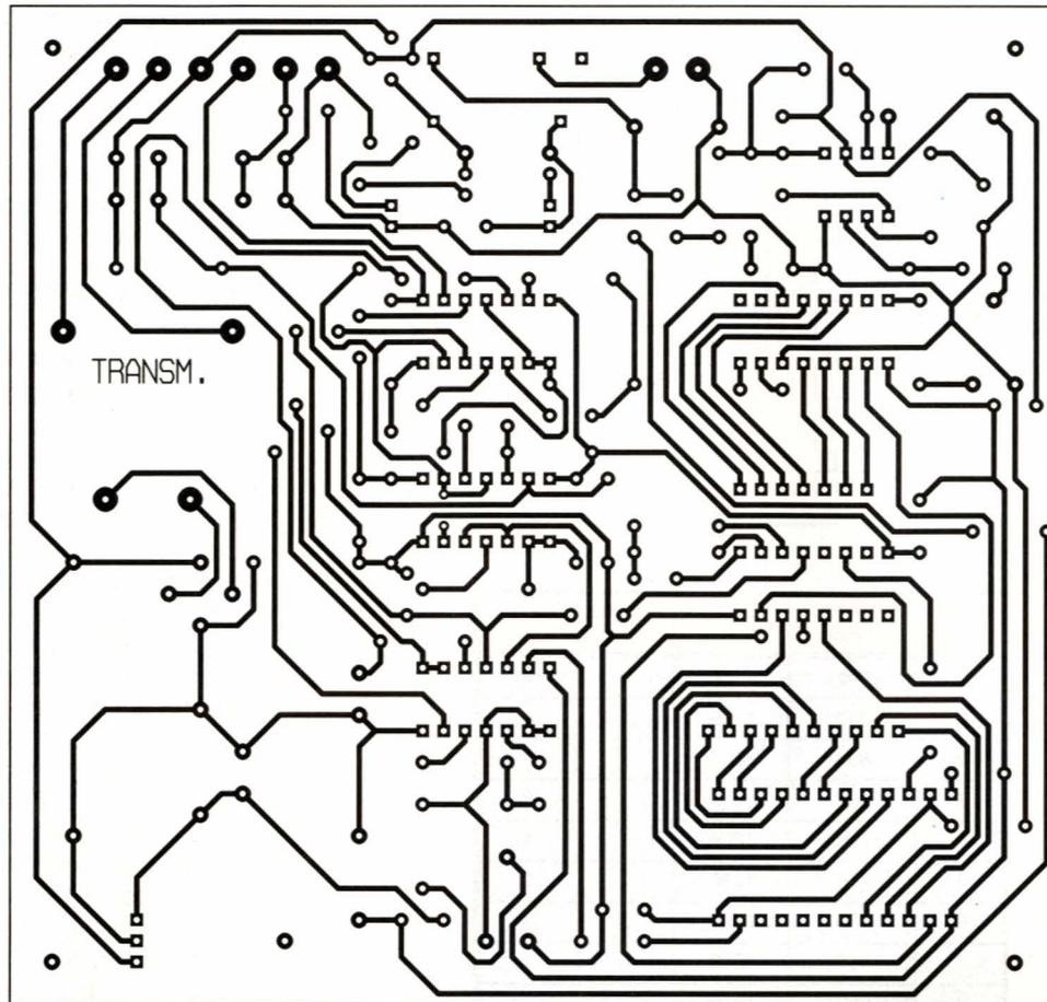
gées et colonnes se rapportent à la structure matricielle d'un clavier téléphonique à touches comportant 4 rangées et 3 colonnes. L'entrée C4 n'est donc pas mise à contribution dans la présente application. Ainsi, si le circuit intégré doit fournir le signal vocal correspondant au chiffre 4 par exemple, il suffira de relier à l'état bas, et de manière simultanée, les entrées R2 et C1. En effet, sur un clavier téléphonique, la touche 4 est située à l'intersection de la 2ème ran-
