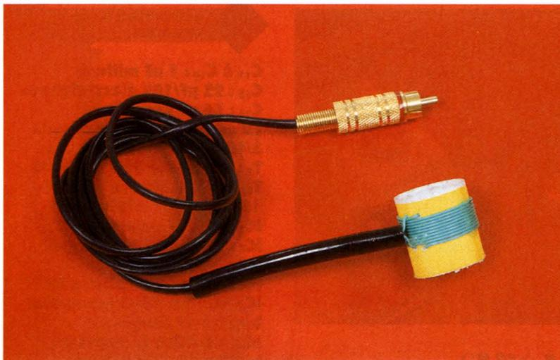
cher le câble HT et d'introduire ce manchon inductif sur le câble avant de le rebrancher.
