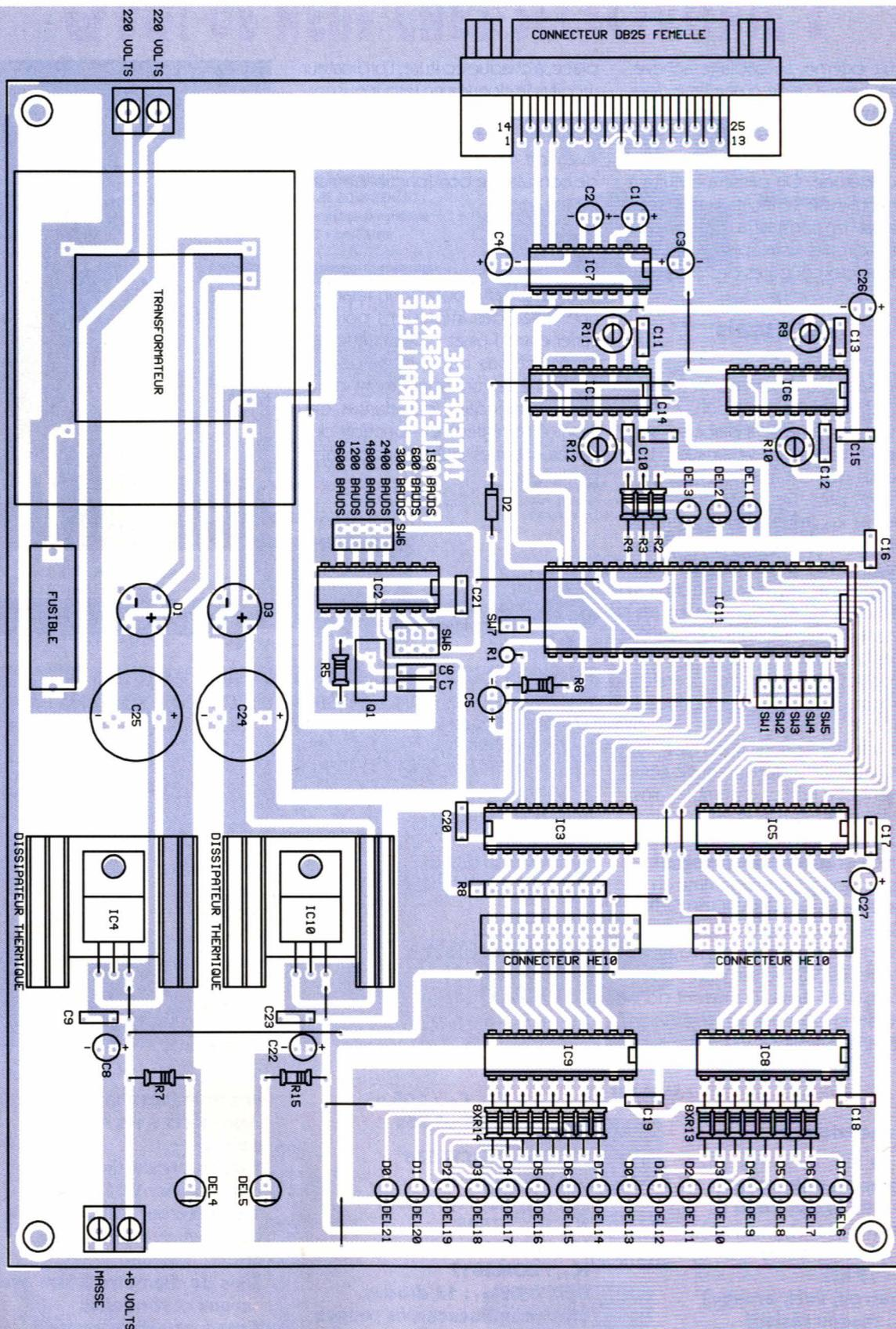
schéma d'implantation des composants représenté en **figure 5** afin de câbler la platine. Celle-ci est de dimensions assez importantes (200mm X150mm), l'alimentation occupant une surface non négligeable. On implantera d'abord les straps dont certains passent sous des circuits intégrés. Ces derniers seront tous placés sur des supports afin de faciliter leur échange en cas de détérioration de l'un d'entre eux.
