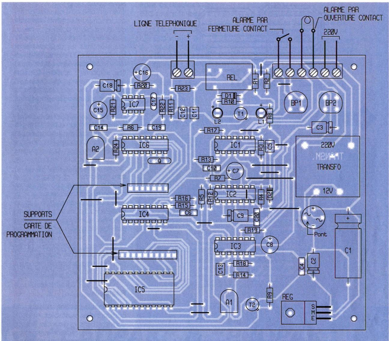
leurs de R21 et C15. L'entrée 7 est affectée à la contre-réaction nécessaire au fonctionnement de l'amplificateur (R20 et C16). Quant à l'entrée 1, et par l'intermédiaire de C17, elle règle le problème de la compensation de fréquence. La capacité C18 est affectée au contrôle de la réjection. Le signal amplifié se trouve transmis dans la ligne téléphonique par le biais de la capacité C12.
