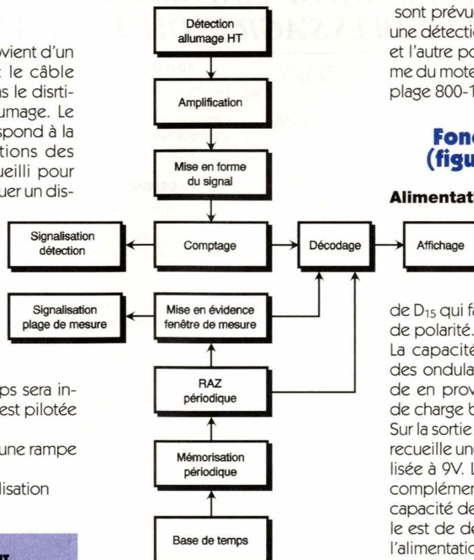
sont prévues : l'une pour visualiser une détection correcte du signal HT et l'autre pour indiquer que le régime du moteur se trouve bien dans la plage 800-1175t/mn.
