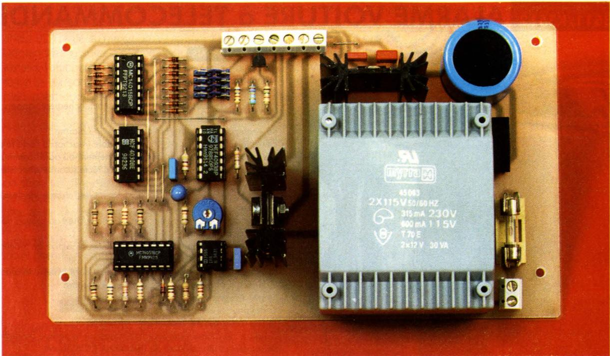
**Il existe parfois des applications, essentiellement d'animation, pour lesquelles il est nécessaire d'obtenir une variation aléatoire d'un mouvement. Ce montage répond à cette attente en permettant de disposer d'une gamme de 8 vitesses différentes se succédant**
