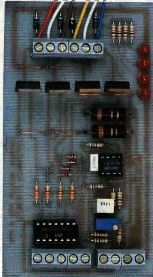
lieu est relié au +VCC, sont groupés deux par deux. Leurs émetteurs sont connectés à la même résistance d'une valeur de  $1\ \Omega$  ( $R_5$  et  $R_6$ ). Le courant traversant les enroulements du moteur traverse également ces deux résistances, ce qui crée un potentiel à leurs bornes.
