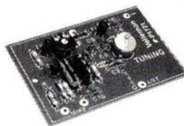
Mini-émetteur FM (100-108 MHz). Préamplificateur incorporé (sensibilité de 5 mV), auquel peut être raccordé tout type de microphone. Alimentation 9-12 VDC. EMISSIONS FAMILIALES, BABYPHONE, SECURITE. Peut être capté par toute radio FM portable ou par tout tuner. Dimensions du circuit imprimé : 45 x 70 mm.
