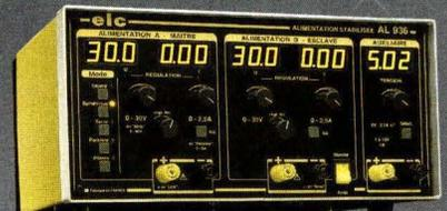
2 x 0 - 30V 2,5A ou 0 - 60V 2,5A ou 0 - 30V 5A et 5V 2,5A ou 1 - 15V 1A ... 3 550 F
