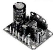
Petit circuit imprimé avec préamplificateur et amplificateur de sortie pouvant être employés séparément. Aucun réglage requis. Protection contre les courts-circuits. Alimentation : 4,5 à 15 VDC. Sensibilité d'entrée amplificateur de sortie : 150 mV (12 V) - préamplificateur : 20 mV (12 V) - Puissance maximale de sortie : 2,5 W (4 $\Omega$ , 12 V) - Dimensions du circuit imprimé : 42 x 32 x 27 mm.
