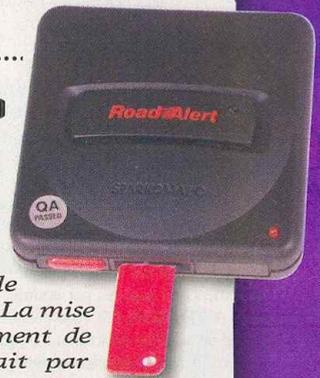
Alarme très simple à installer, pas de câbles à passer. La mise en fonctionnement de l'alarme se fait par l'appui sur le bouton rouge, elle devient active 90s après l'appui sur ce bouton. L'arrêt de l'alarme se fait en introduisant la clé dans la fente prévue à cet effet. Un délai de 10s est prévu dans le système avant la mise en route de la sonnerie pour vous laisser le temps de désactiver l'alarme quand vous entrez dans le véhicule. Sensibilité réglable en fonction du volume du véhicule.
