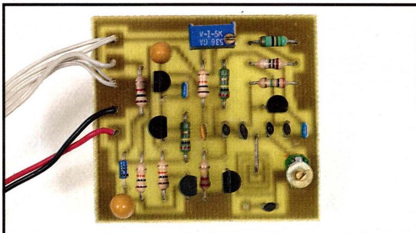
l'émetteur FM équipé d'un oscillateur Colpitts
