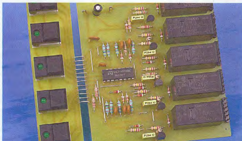
Utilisation de boutons poussoirs du type "Shadow" à led intégré
