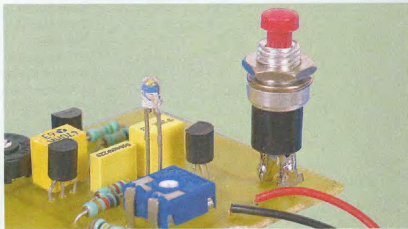
Position de la led et du bouton poussoir
