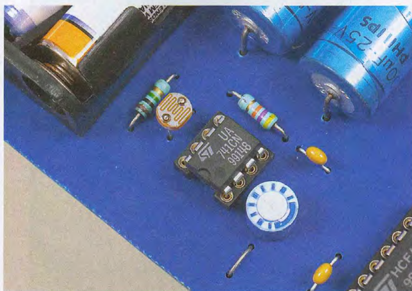
On distingue la photo-résistance
