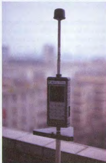
La sonde isotropique large bande
