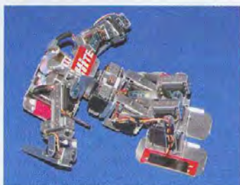
Allongé par terre, le robot Hitec s'apprête à se relever tout seul pour une séance de danse ! Il utilise 21 servos conçus pour la robotique
