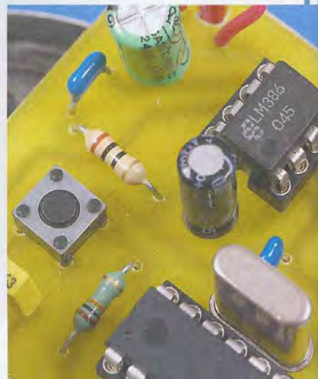
Utilisation du circuit audio LM386
