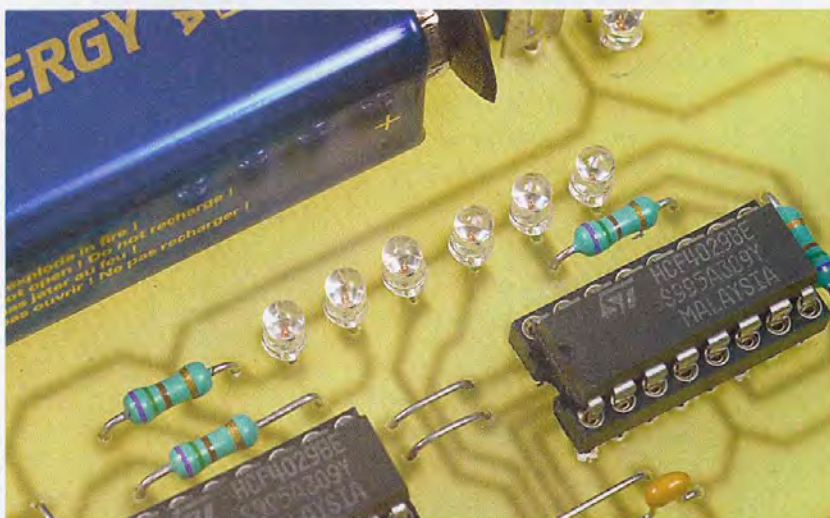
Des diodes LED signalent l'état binaire des sorties Q des compteurs GD4029
