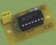
μP 65 : Clignotant pour passage à niveau
