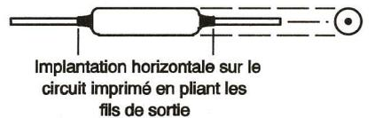
Implantation horizontale sur le circuit imprimé en pliant les fils de sortie
