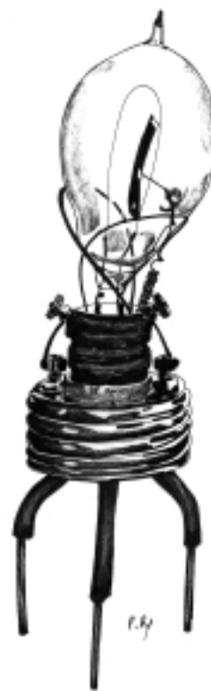
Le premier tube réalisé en laboratoire (Diode)
