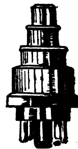
Fig. 1. — Lampe-phare utilisée pour produire les ondes décimétriques. On aperçoit à la partie inférieure le culot à broches et son ergot central.
