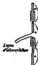
Fig. 7. — Dans le cas de la polarisation verticale, on peut décaler un manchon d'un quart d'onde en changeant de sens l'extrémité ouverte, pour éviter l'action de la pluie, de la neige ou du givre.
