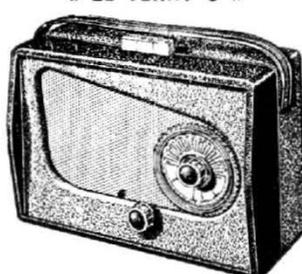
5 transistors Thomson + diode; 2 gammes d'ondes PO-GO; 3 touches (dont une « arrêt ») sur clavier; HP de 12 cm gros aimant spécial transistors; cadre 20 cm incorporé avec bobinage voiture. Boîtier gainé 2 tons au choix (beige, gold, vert, bleu et grenat).
