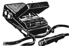
4,75 cm/s - Double piste - 1 heure d'enregistrement/lecture - Alimentation 5 piles 1,5 V - Autonomie 18 h - Rebobinage rapide AV et AR - Contrôle par vu-mètre - Dim. : 115 x 105 x 55 mm - Poids 1,5 kg.
