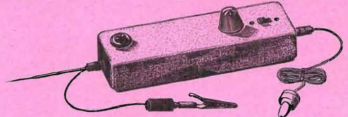
FIG. 3. — L'ordre des jacks mâles est à inverser (écouteur côté bouton-poussoir).
