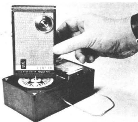
tion utilise, en fait, la tension de contrôle de volume automatique, et permet d'effectuer sa mesure en observant l'aiguille qui se déplace sur le cadran d'un appareil de mesure.
