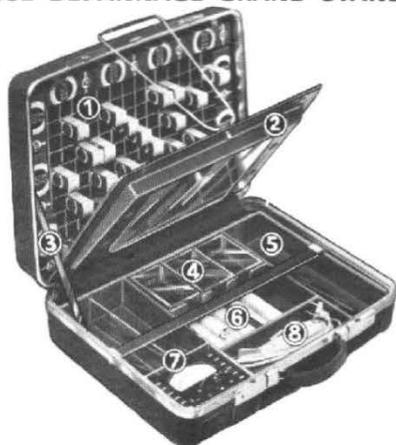
1 - Casiers pour tubes, dont 12 gros module. - 2 - Porte cache-tubes amovible équipée d'une glace rétro et d'un chevalet et munie d'un porte-document au dos. - 3 - Sangle amovible de retenue de couvercle. - 4 - Boîtes en plastique transparent. - 5 et 6 - Compartiments pour outillages divers et pour trousse mini-bombes Kontakt-Service. - 7 - Par jeu de cloisons mobiles, emplacement pour tous les types de contrôleurs. - 8 - Logement pour tous types de fer à souder Engel et leurs panes
