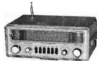
GR 78 Récepteur de trafic toutes bandes portatif trans- istorisé 190 kHz à 30 MHz en six bandes - AM, CW et SSB - Alimentation par batterie rechargeable Prix - kit : 1.380 F TTC - Monté : 1.780 F TTC
