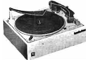
Changeur automat. monté sur socle, 16, 33, 45, 78 t., passe les disques tous diamètres (16 à 30 cm) dans n'importe quel ordre consécutif (dans une même vitesse), plateau lourd 268 mm, bras avec cellule magnét. stéréo SHURE M7DM, préampli magnét. incorporé, moteur 110/220 V - larg. 365, prof. 307, haut. 185 mm - livré avec cordon secteur et liaison BF (prise DIN 3 br.), axes changeurs 33 et 45 t. .... **299,00**
