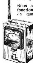
Nous avons ici un appareil à fonctions multiples : contrôleur de quartz, émetteur étalonné, indicateur de champ. Contrôleur de quartz. Il permet de constater si un quartz oscille correctement et d'apprécier son amplitude d'oscillation. 2 supports, européen et américain. Emetteur étalonné. Ici le CM.2 rayonne sur son antenne une
