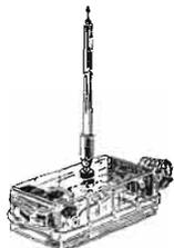
Petit récepteur destiné à faciliter la mise au point d'un émetteur. Il reçoit sur circuit oscillant étalonné et comporte un galvanomètre indicateur d'accord maximum. Sur 27 et 72 MHz. Prix en pièces détachées 60,00
