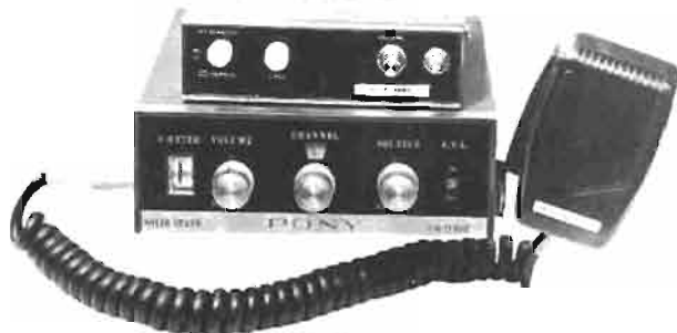
Le dispositif d'appel sélectif BST707 disposé sur la partie supérieure d'un radiotéléphone PONY CB71BST
