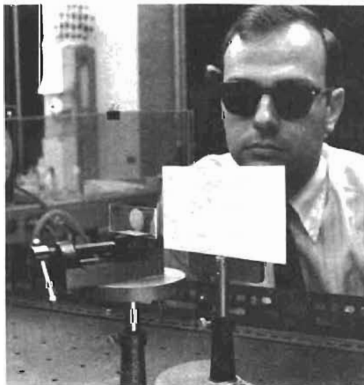
Photo 1. — Deux déflecteurs acousto-optiques en cascade. Un tel montage permet de dévier le faisceau laser en 1 600 positions différentes, en une microseconde au maximum
