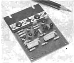
AMPLIFICATEUR HI F I Z 30 DE 20 W
