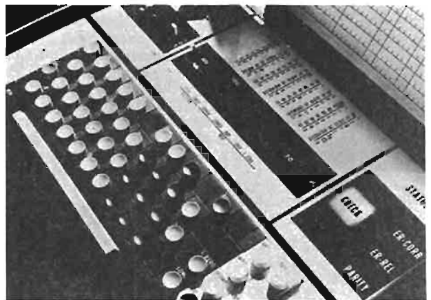
Photo 10. — Clavier standard du keytape à 7 canaux : Le clavier standard compte 34 touches et une barre d'espacement permettant de composer 64 caractères différents : 26 lettres, 10 chiffres décimaux,
