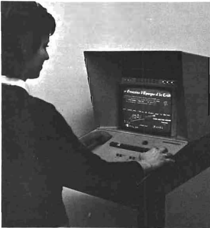
Photo n° 3 : Dans certaines banques de données, les informations sont stockées sur microfilms et microfiches. Des installations de télévision en circuit fermé ont été conçues pour consulter, à distance, ces informations. (Cliché C.D.C.)
