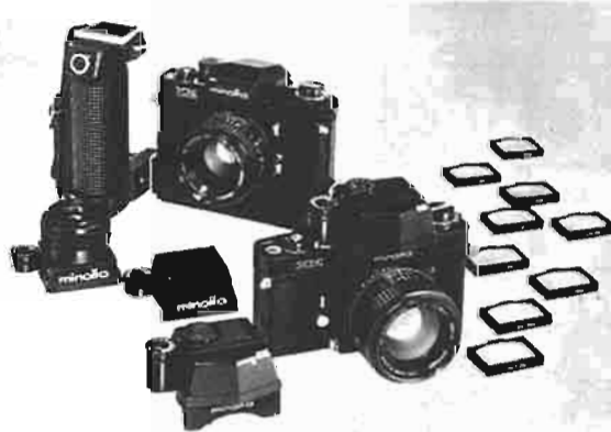
Fig. 6. — Minolta XM avec son moteur d'entraînement, les différents viseurs et les écrans.
