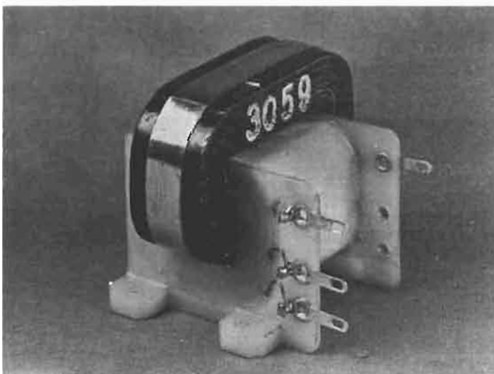
Fig. 2. — Transformateur de sortie « images » aux pertes très réduites, car utilisant un circuit magnétique spécial en double (C-Core). Photo CSF-Orega. Page 202 - N° 1429
