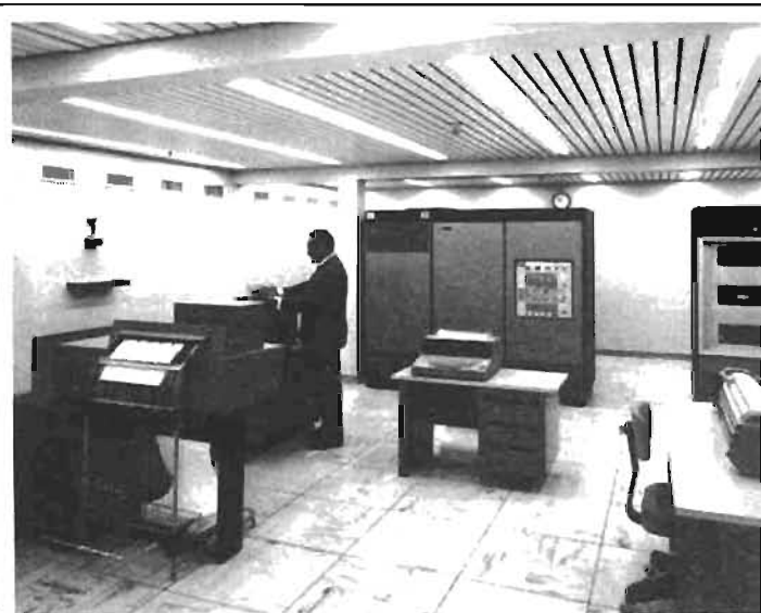
Photo 18 - Afin de réaliser des configurations, à la fois puissantes et homogènes, d'ordinateurs de conduite automatique, des calculs techniques, de calculs scientifiques et de gestion, l'IBM 1800 peut être muni d'un adaptateur autorisant la liaison avec de gros ordinateurs des séries 360 ou 370.
