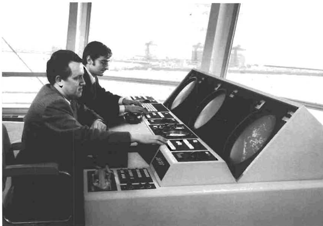
Photo 2. — Dans la salle de vigie du sémaphore du port du Havre. Les contrôleurs disposent des images radar présentées sur écrans de télévision à haute brillance.
