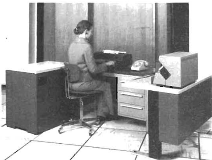
Photo 12 - L'IBM3735 est un terminal de transmission par lots qui unit des qualités de mémoire et de logique à des facultés de calcul et d'édition. Connecté à l'ordinateur, il est à la fois enregistreur des données frappées au clavier, émetteur des données qu'il communique à l'unité centrale et récepteur des résultats de celle-ci. Il est équipé d'un disque magnétique qui stocke les données du jour que l'opérateur frappe au clavier de sa machine à écrire.
