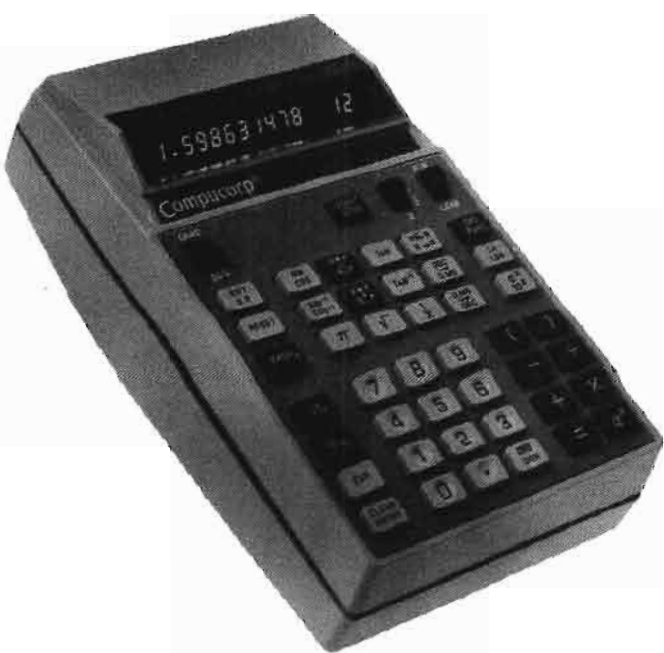
Photo 12. - Le modèle 324 G « scientifique » de COM-PUCORP est programmable et dispose de deux mémoires capables de stocker, chacune, jusqu'à 80 pas de programmes.
