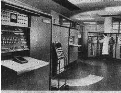
Photo 7 - Univac-Solid State 1 : le premier ordinateur entièrement transistorisé.
