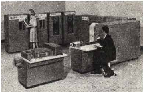
Photos 9 - a) En 1960, la NCR annonce le NCR-315, ensemble électronique de gestion, utilisant une mémoire de masse à feuillets magnétiques (mémoire « CRAM »). En 1961, le NCR-315 fonctionne en temps réel. En 1966, le NCR-315 sera doté de films minces pour sa mémoire interne, dont le temps d'accès atteint 800 nanosecondes.
