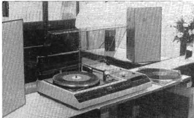
Photo 6 - La chaîne compacte, ici avec magnétophone à cassette, tourne-disque, tuner, amplificateur, 2 enceintes. Une formule qui se développe, même chez les constructeurs japonais.
