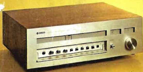
Tuner CT 7000 à transistors à effet de champ pour une sensibilité et une sélectivité exceptionnelles.
