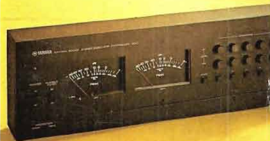
Préamplificateur comparateur d'enceintes UC1 avec niveau ajustable individuel pour chaque enceinte
