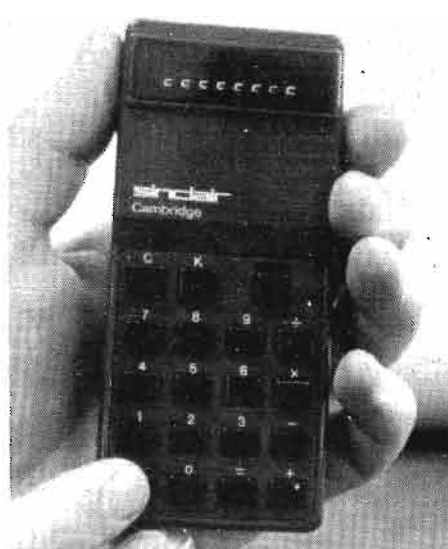
c) On trouve dans le commerce des calculateurs en « kits » : le calculateur « Cambridge » de la firme britannique Sinclair. En trois heures, vous pouvez l'assembler chez vous et économiser, ainsi, plus de 50 francs. Ce modèle est pourvu d'un affichage à 8 digits et à virgule flottante.
