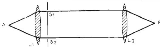
Fig. 7 - L'interféromètre de Rayleigh. Une fente source, étroite, est placée au foyer d'une lentille L1 derrière laquelle est placé un écran percé de deux fentes S1 et S2. Une seconde lentille L2 focalise les deux faisceaux émis par les deux « pseudo-sources » S1 et S2.
