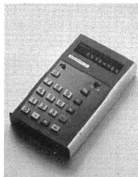
d) Aux quatre opérations classiques certains calculateurs offrent des facilités supplémentaires : Le calcul des pourcentages, par exemple, est micro-programmé dans bien des modèles, tel le 80C de Adler...
