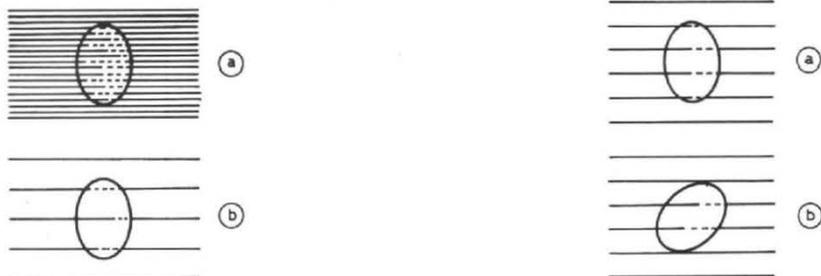
Fig. 5. — Dans un champ fort (a) les lignes de forces sont plus « serrées » que dans un champ faible (b). Il y a donc plus de flux dans une même surface si le champ est fort.
