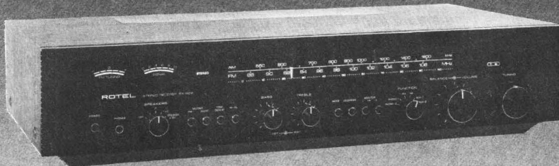
L'accord exact sur une émission F.M. donne en sortie de discriminateur une tension nulle, ni positive, ni négative. Le vu-mètre à zéro central visualise cette tension.
