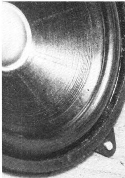
Photo 3 : détail du boomer : cône d'alliage d'aluminium embouti et nervure de renforcement de la membrane.
