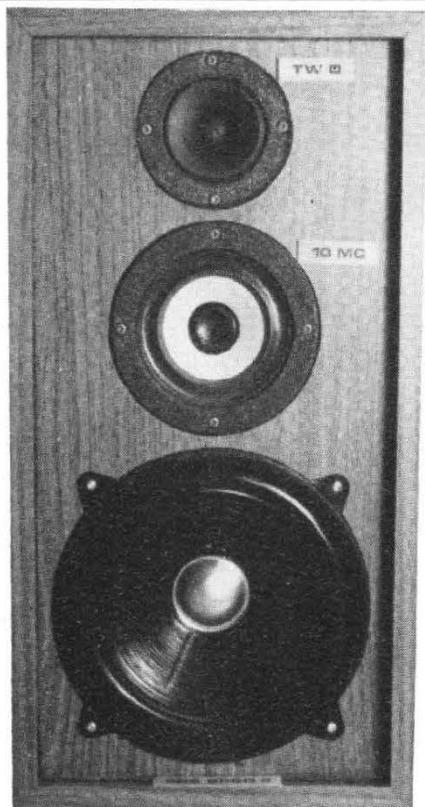
Photo 1 : Enceinte de démonstration utilisant les trois haut-parleurs décrits ci-contre. De bas en haut 205 SPCG 3, 10 MC et TW 0.
