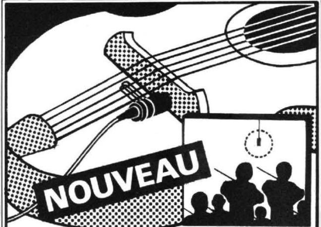
**MICROPHONE OMNIDIRECTIONNEL A EFFET ELECTRET EO-697**
