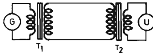
Fig. 14. - On minimise les pertes en ligne en élevant la tension au départ par le transformateur T_1 et en la ré-abaisant à l'arrivée par le transformateur T_2 .
