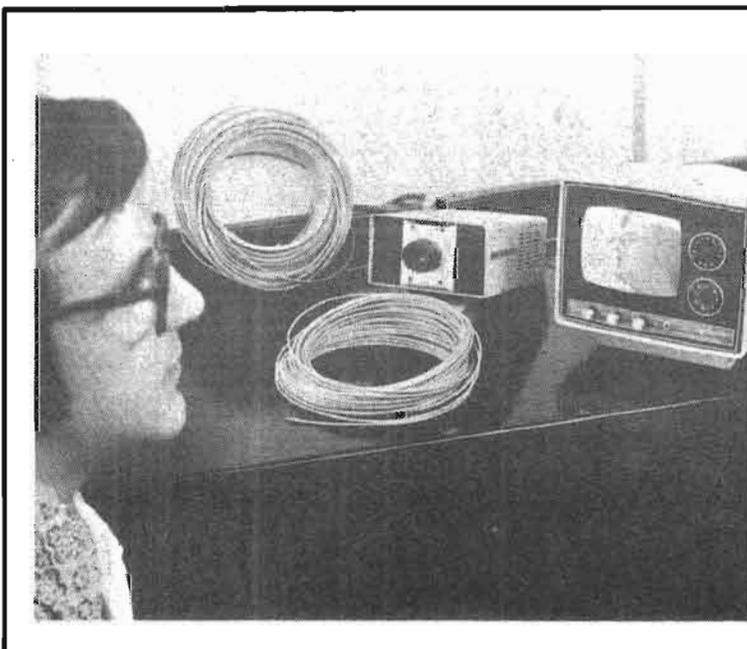
Photo 1. - T.V. à fibres optiques : les signaux vidéo modulent une diode électro-luminescente ; celle-ci est couplée, à un faisceau de fibres optiques de plusieurs centaines de mètres de longueur. A l'autre extrémité se trouve un détecteur relié au poste de télévision (photo Corning Glass Works).
