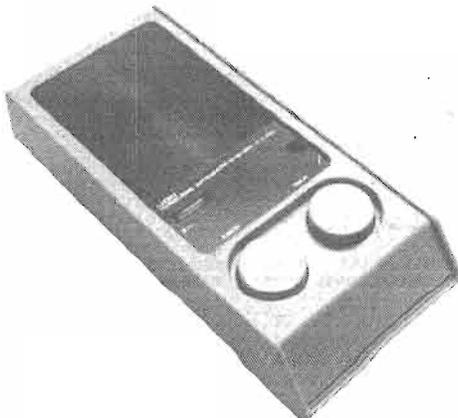
CET interphone utilise les fils du secteur comme fils de liaison entre les différents postes. Comme tous les appareils de ce type ils ne peuvent être utilisés que sur une même installation électrique, c'est-à-dire sur des prises de courant dépendant d'un même compteur.
