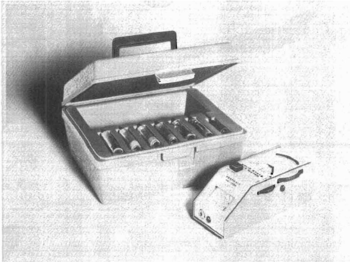
cit  ou d'une inductance, la mesure du Q d'un circuit accord , voire l'emploi en mesureur de champs, outre les fonctions dynamiques ou statiques de mesures de fr quence. Le grid dip peut donc   lui seul remplacer une demi-douzaine d'appareils de mesure sp cialis s, avec une pr cision tr s largement suffisante dans la majorit  des cas.
