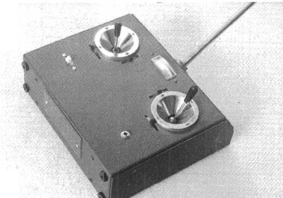
Photo 1 : Aspect de l'émetteur TF6 terminé.
