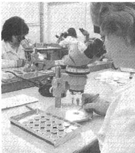
Photo 4. - Les horlogers Suisses achètent des mécanismes britanniques : le quartz vibre à la fréquence de 768 432 Hz ; il alimente des diodes électroluminescentes par l'intermédiaire d'un circuit intégré diviseur de fréquence. (Cliché Hughes Microélectronics Ltd).
