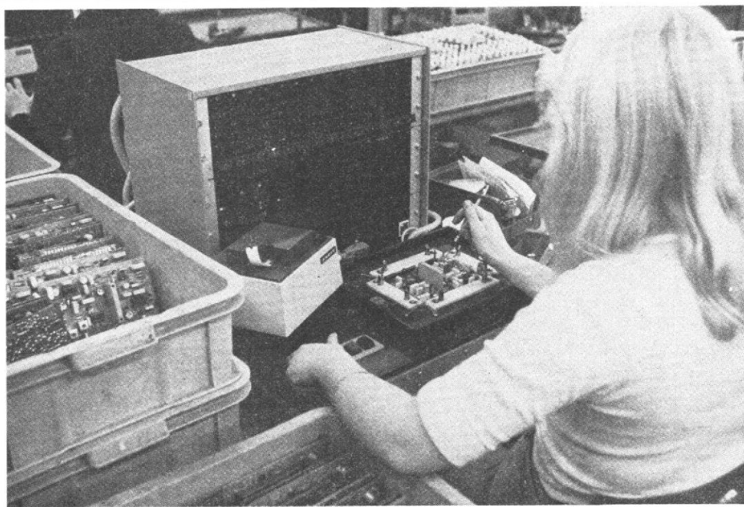
Photo 6. - Réglage d'une platine T.V. sur banc-test spécial. L'imprimante délivre une fiche indiquant l'emplacement du défaut.
