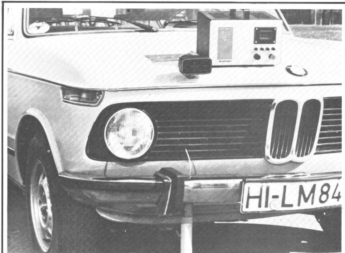
Photo 4. - L'antenne ferrite installée dans le bas du pare-chocs de cette voiture. Sur le capot, nous voyons l'indicateur de direction et un boîtier avec codeur par roues.
