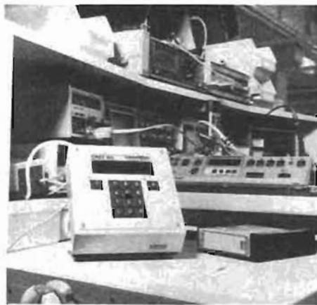
Photo 5. - Avec ce mini-terminal DMT 80, les indications de pannes et les défauts sont codés et introduits dans l'ordinateur du système de qualité.
