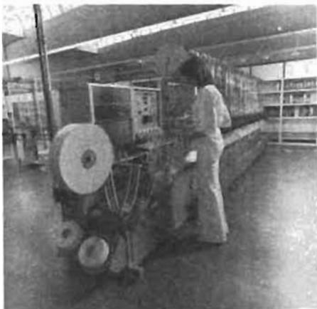
Photo 3. - Ces séquenceurs sont alimentés par des rouleaux de composants divers et en font un ruban de composants mélangés.
