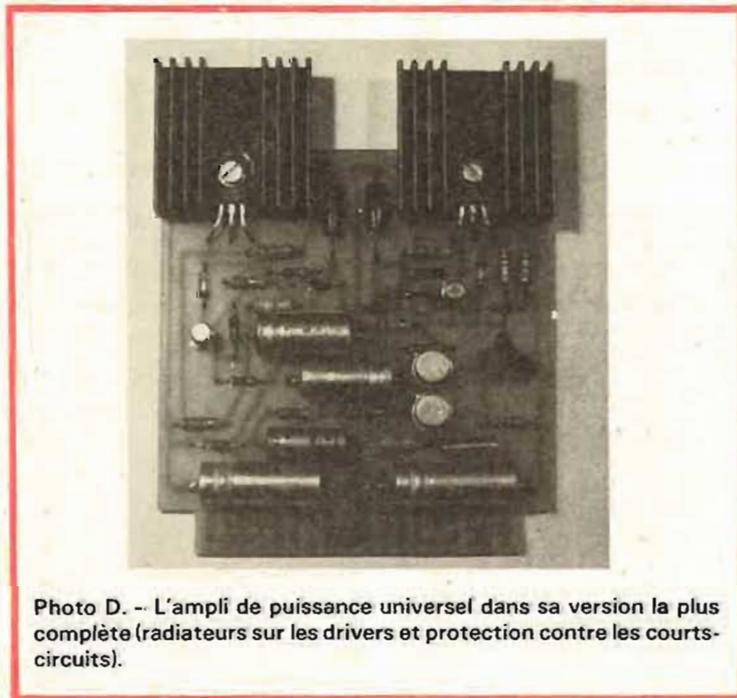
Photo D. - L'ampli de puissance universel dans sa version la plus complète (radiateurs sur les drivers et protection contre les courts-circuits).
