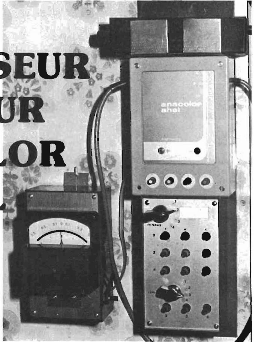
**L**A détermination du filtrage en agrandissement couleur est considérablement simplifiée avec l'utilisation d'un analyseur, à condition que la sonde soit un tube photomultiplicateur. Or dans cette catégorie d'appareils le modèle présenté par AHEL est de loin le moins onéreux (environ 1400 F), bien qu'il semble être équipé de la même électronique de base et du même boîtier-sonde que ses concurrents les plus sophistiqués : il était donc tentant de remplacer ses deux LED témoins par un
