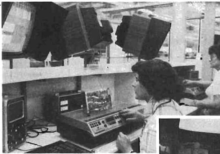
Photo 10. - Poste de contrôle des circuits intégrés, au contrôle d'entrée. Ici les CI sont contrôlés à 100 % sur le circuit réel d'utilisation.
