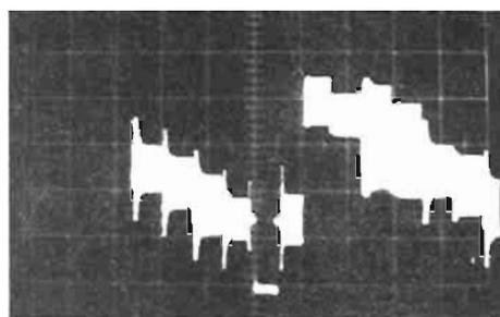
Fig. 16. - Par la commande de retard de balayage, et en position « recherche » du commutateur, on éteint le début de l'oscillogramme, jusqu'à la zone à détailler.
