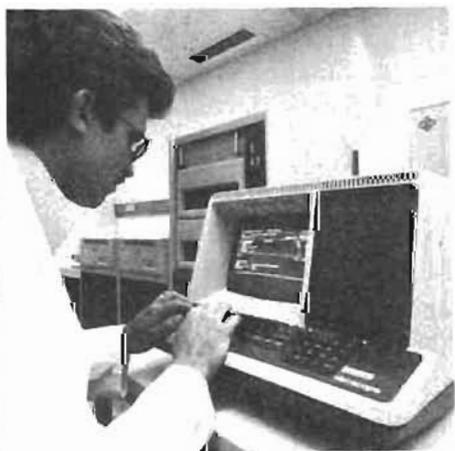
Photo 6. - Dans l'usine de magnétoscopes Grundig, des terminaux à visualisation permettent de démarrer des programmes d'évaluation du niveau de qualité, en fonction de divers critères, et d'obtenir des renseignements sur les défauts systématiques.
