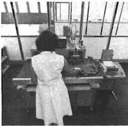
Photo 4. - Sur cette machine à double tête, les composants à sorties axiales montés sur ruban et dont l'ordre de succession correspond au montage, sont insérés sur le circuit imprimé.
