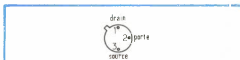
Fig. 19 a. – Vue de dessous du TAA 320. Ce composant nécessite une alimentation de plus de 10 V.
