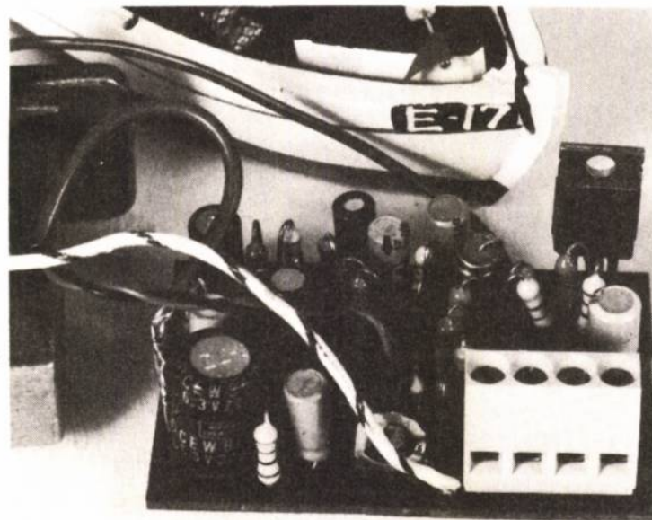
Photo B. - L'électronique du radar Doppler. Deux bornes servent pour le relais, deux pour l'alimentation.
