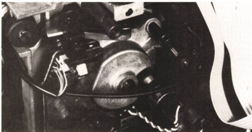
Photo C. — Nous voyons ici le moteur du cabestan, il est tout petit et monté sur un bras. On voit également le châssis en métal moulé, rare dans un magnétophone à cassette.
