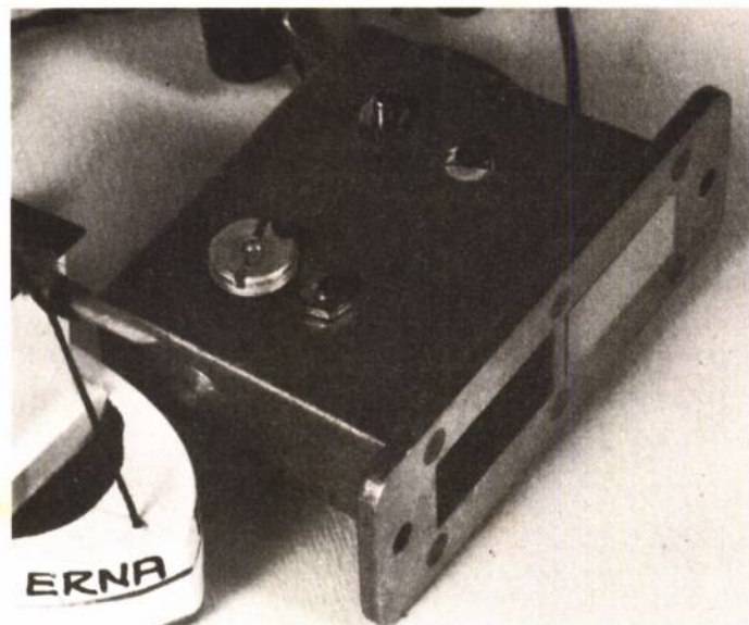
Photo A. - L'émetteur/détecteur SMX 5 de Siemens, il est livré pré réglé.
