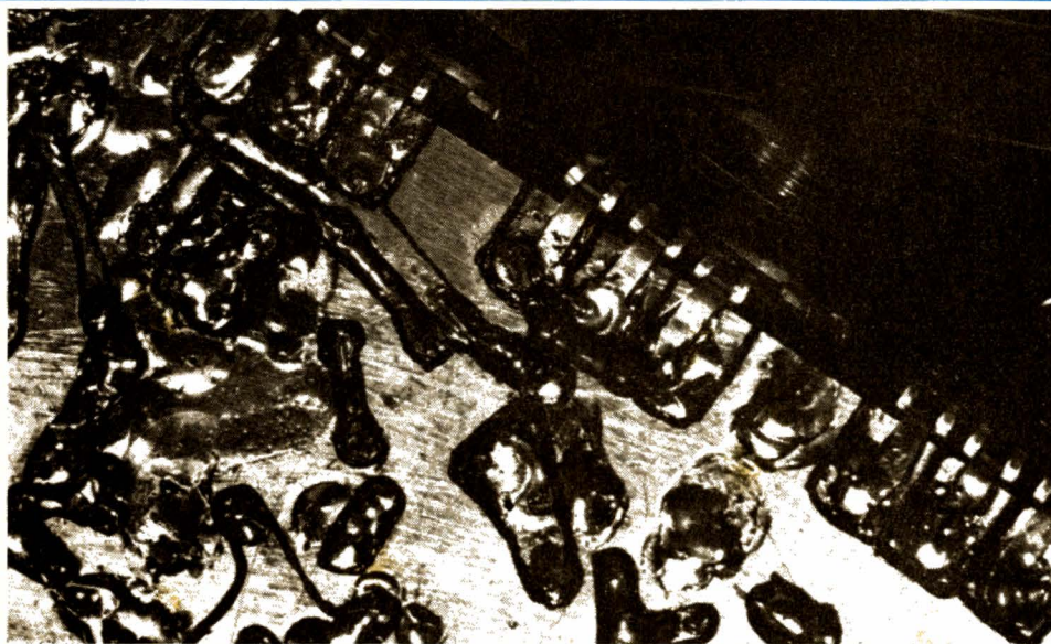
Photo B. — Cette vue montre comment on peut souder les potentiomètres directement sur le circuit imprimé. Ici, une résistance placée en parallèle sur un potentiomètre permet de réduire sa plage de fonctionnement, nous avons pris ici un potentiomètre de 100 k \Omega en parallèle sur une 33 k \Omega pour remplacer le potentiomètre de 22 k \Omega que nous n'avons pas en stock.
