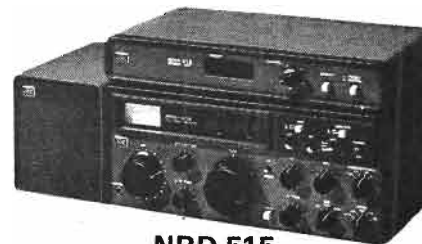
NRD 515 Récepteur de 100 kHz à 30 MHz AM / SSB / CW, de classe professionnelle
