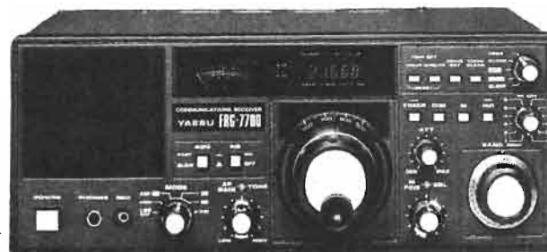
FRG 7700 Récepteur à couverture générale 150 kHz - 30 MHz, AM / FM / SSB / CW, affichage digital, alim 220 V Option: 12 mémoires et 12 V
