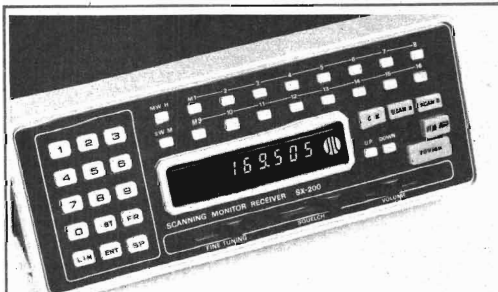
Photo A. - L'indicateur lumineux donne directement la fréquence de réception. A gauche, le clavier permet de programmer sa fréquence. Au-dessus, nous avons les touches de stations pré-réglées.
