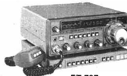
FT 707 Émetteur et récepteur amateur 100 W ou 10 W, mode AM / SSB / CW, nouvelles bande équipées, nombreux accessoires
