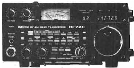
IC 720 Récepteur de 30 kHz à 30 MHz. Transceiver amateur 100 W, CW / AM / SSB / RTTY. Alim. 12 V. Nombreux accessoires
