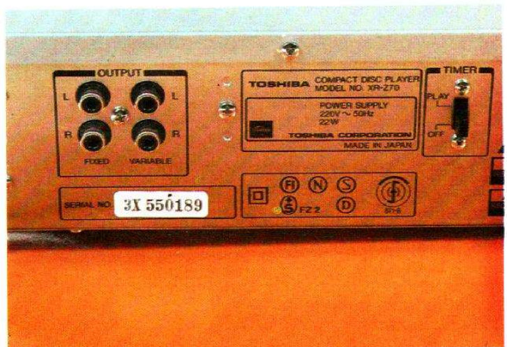
Photo 5. - Le branchement avec l'interrupteur de départ avec minuterie.
