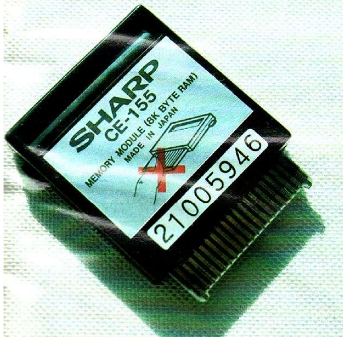
Photo 3. L'extension RAM : admirez la finesse du connecteur.
