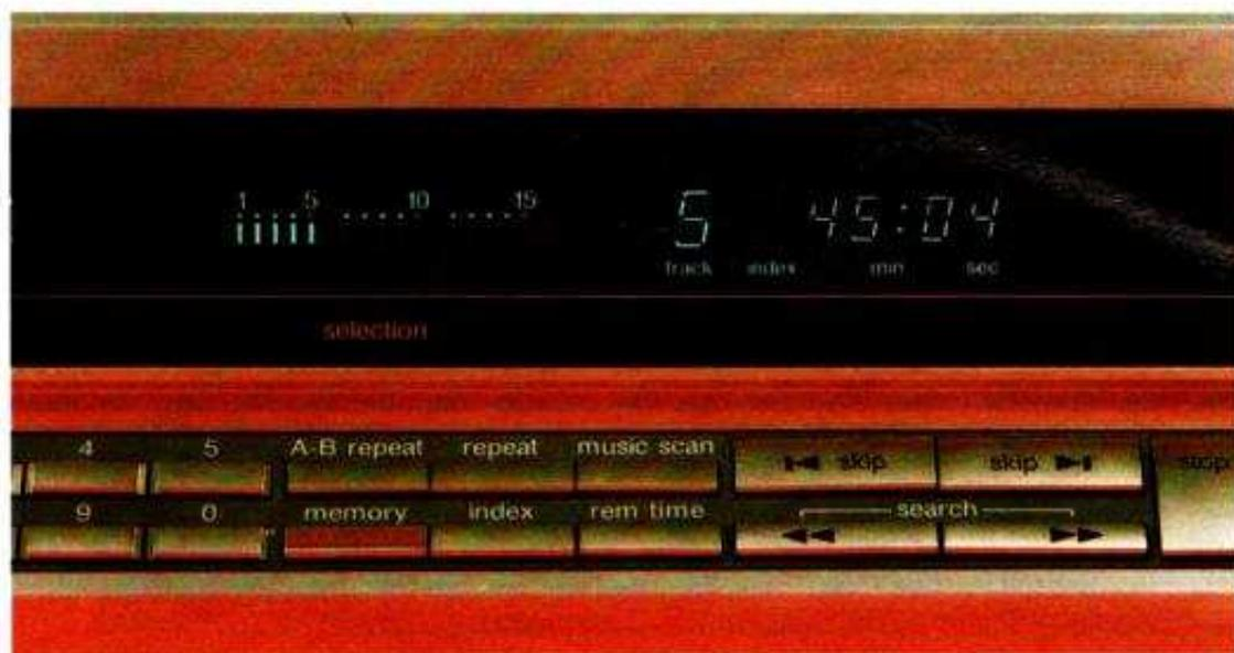
Photo 1. - L'afficheur fluorescent et le clavier.
