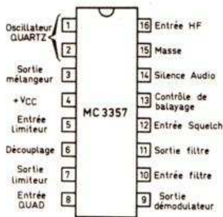
FIGURE 5. - Brochage, vue de dessus.
