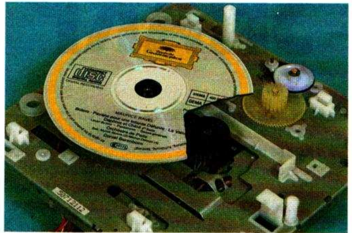
Photo 3. - La mécanique vue de dessus : notre disque coupé permet de mieux comprendre le fonctionnement du dispositif de lecture.
