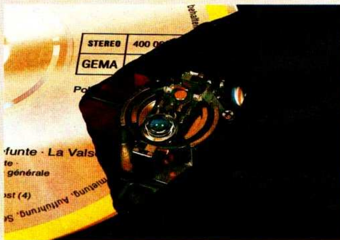
Le laser déshabillé : on voit la bobine cylindrique avec l'objectif. Au premier plan, on remarque un aimant et une petite bobine, c'est elle qui permet la rotation du système, et donc, le suivi de la piste.
