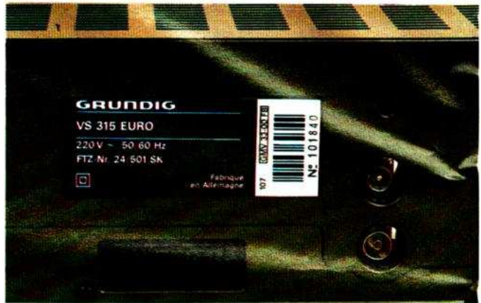
Les prises arrière : entrée et sortie antenne et prise peritélévision.
