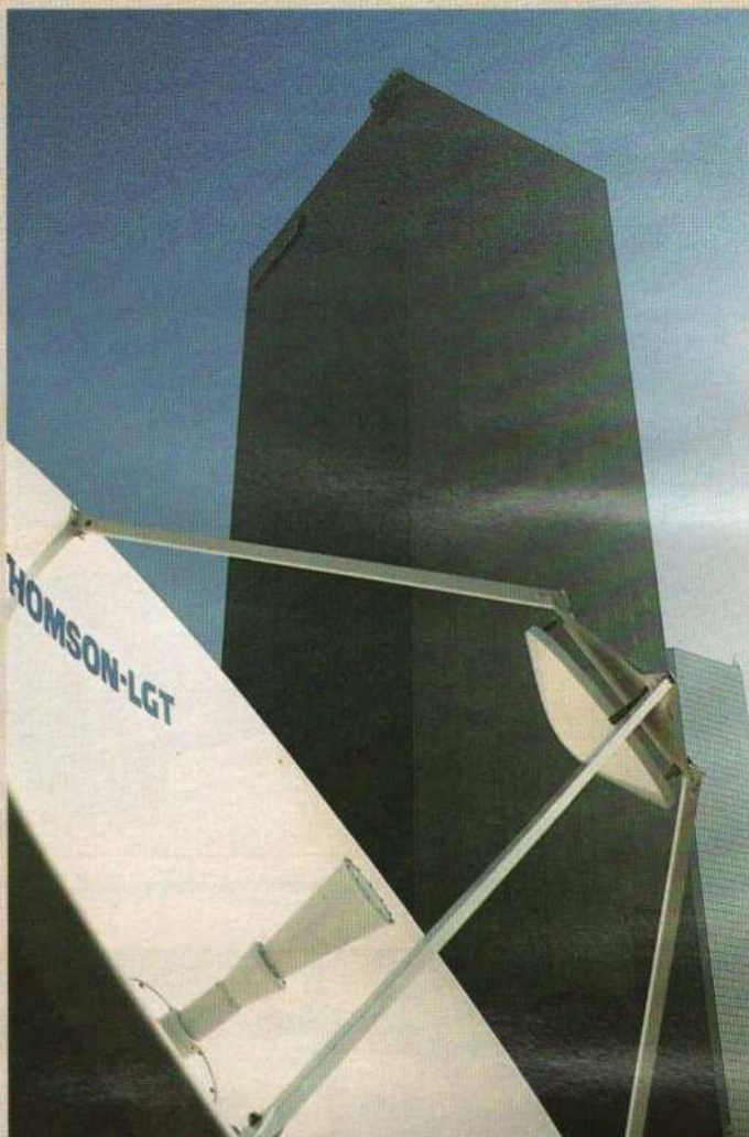
Antenne Cassegrain à l'ombre des buildings.
