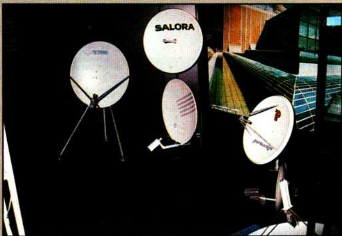
Chez TDF, quelques paraboles de petit diamètre, de divers fabricants, pour le grand public. Au mur, le centre d'émission et de réception de Barcenay-en-Othe, près de Troyes. C'est de là que partiront les programmes pour TDF 1.
