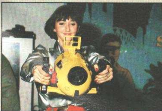
Comme un poisson dans l'eau : le Handycam de Sony est protégée par ce coffret étanche supportant une immersion à 40 m. La grille protège un microphone piézo électrique étanche.
