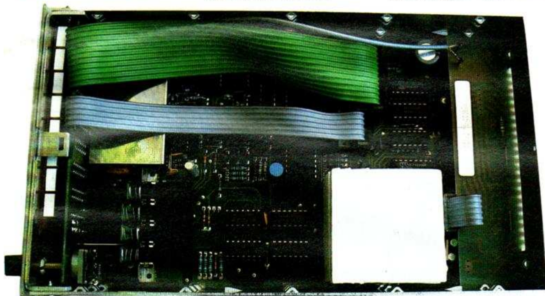
L'intérieur du fréquencemètre. Remarquez le boîtier en polystyrène qui contient la base de temps thermostatée.
