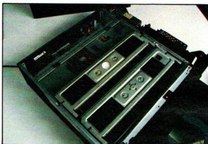
A droite : les deux rails supportant chacun un plot de centrage. Le plus à droite pour les LV, l'autre pour les CD et CDV. La tête de lecture est en position de lecture des LV.
